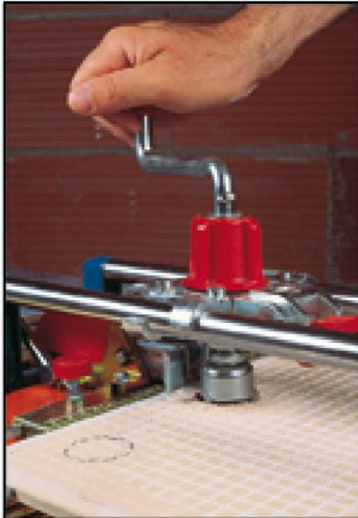
Exemple de trépan manuel adaptable sur les rails d'une carrelette.
