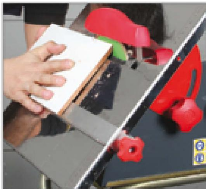
Exemple de coupe en biseau avec inclinaison de la table.
