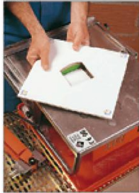
Coupe au centre d'un carreau
